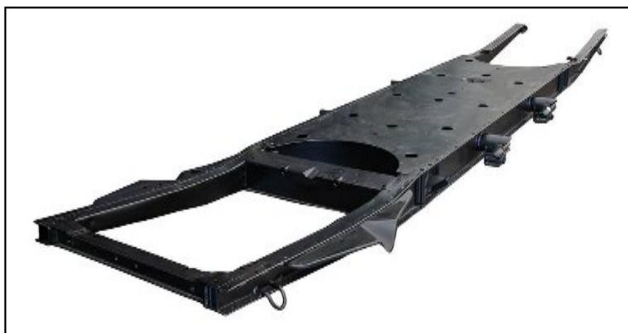
Châssis avec peinture par immersion cathodique
